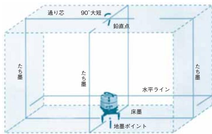
電子気泡管センサと超減速比コアレスモータの組み合わせにより置くだけで自動整準します。
